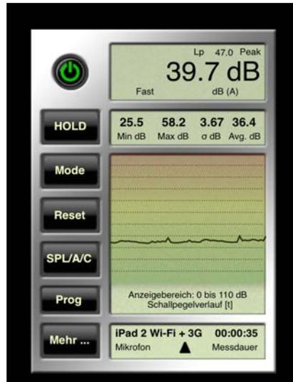
Abbildung 3: Applikation „Noise Hunter Version 1.0.1“ über i-Pad2 (Quelle Nessmann 2013)
